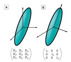
Рис. 4. Матрица, задающая форму и направление диффузионного эллипсоида (а), и результат диагнонализации этой матрицы (б). D – элементы матрицы, представляющие собой измеренные в различных направлениях коэффициенты диффузии;  $\lambda$  – собственные числа диффузионного тензора, соответствующие длинам полуосей эллипсоида диффузии.
